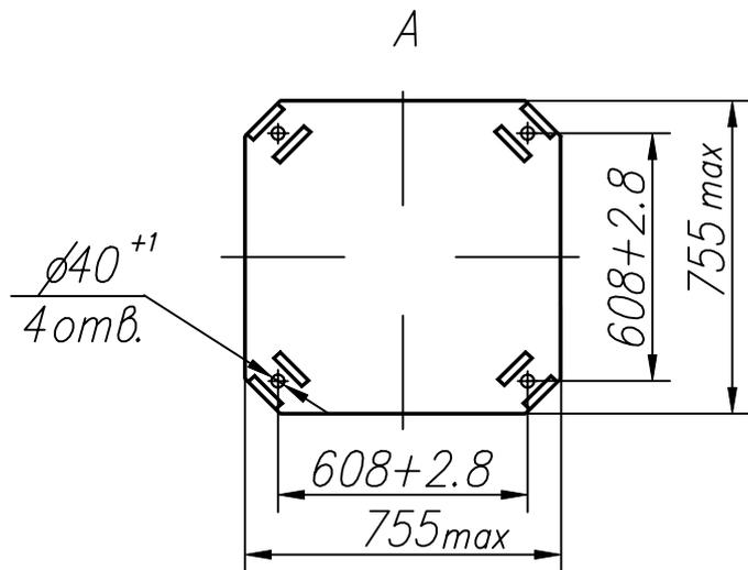
2. Герметичные корпуса кассет необслуживаемого оборудования (для установки в цистерны и грунтовые корпуса)
